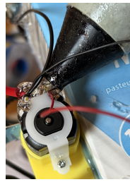
(b) Kontakte befestigen und versiegeln
